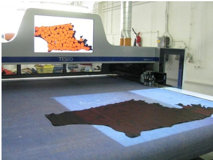
6.ábra: A Szamos Cipőipari és Kereskedelmi Kft által alkalmazott automatikus bőrszabó gép forrás: JUHÁSZ ANDREA, elektronikus levél , 2015.augusztus.12
