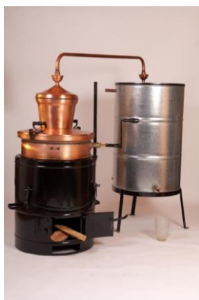
1.kép: Kisüsti lepárló berendezés (forrás: internet)
