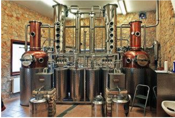
2.kép: Erősítő feltétes lepárló berendezés (forrás: saját felvétel)
